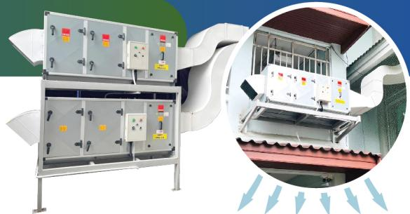
ทำด้วยแผ่นเหล็กหรือเหล็กอ่อนสังกะสี ภายในประกอบด้วย Pre filter มาตรฐาน MERV 8 ASHRAE 52.2 / Medium Filter มาตรฐาน ASHRAE 52.2 / HEPA filter มาตรฐาน EN1822 ประสิทธิภาพในการกรองอนุภาคขนาด 0.3 micron ขึ้นไป 99.99%, Class H14 และพัดลมระบายอากาศเป็นชนิด Centrifugal Fan, Plug Fan หรือ EC. Fan ใช้กับระบบไฟ 220 V. / 1 PHASE 50 Hz หรือ 380 V. / 3 PHASE 50 Hz
